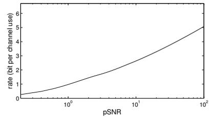
(d) Capacity under box constraint.
