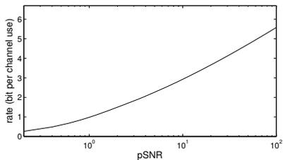
(d) Capacity under circle constraint.
