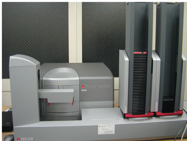
図1. インベータ法により蛍光強度を観測するための機械。 （写真提供：癌研究会ゲノムセンター）
