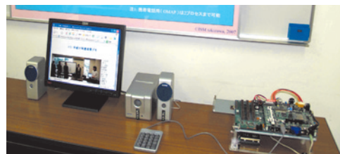
図3 無線通信用組み込みシステムプロトタイプ。図中、右は組み込みコンピュータ、左は音響出力及びディスプレイ。
