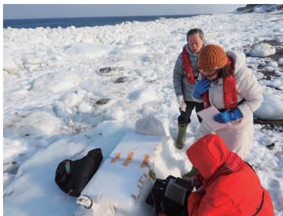
写真5：周波数を下げて試作した2台目のアンテナで、北海道・紋別の流水を計測した。手前の白い筐体には送信アンテナ、奥の筐体には受信アンテナが入っている。
