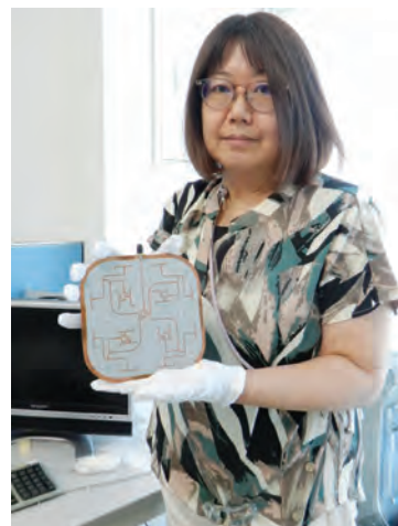
写真1：深澤と瀧澤が開発したX-bandマイクロ波円偏波アンテナの下面。各要素アンテナへのマイクロ波給電回路が迷路のように張り巡らされている。周囲を囲んでいるのが、横方向伝搬を抑制するカラー（緑）だ。掌に載るほどコンパクトだが、パワーは強い。
