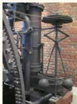
フィードバック制御器の発端となった遠心调速機 写真は「ウィキペディア (Wikipedia) : フリー百科事典」( https://en.wikipedia.org/wiki/File:Boulton_and_Watt_centrifugal_governor-MJ.jpg ) より引用
