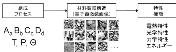
図 8. プロセスと組成からの材料微細組織の予測と組織から特性の予測。材料組織を電子顕微鏡画像で表現することで、前者のタスクは画像生成、後者のタスクは画像認識に帰着する。
