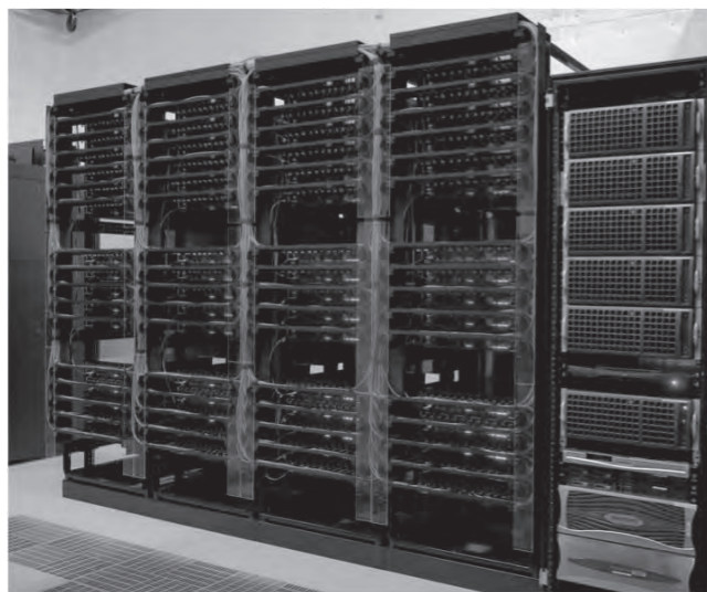
図：MDGRAPE-4 全体システムの写真。全部で64ノード、512チップを有する。
