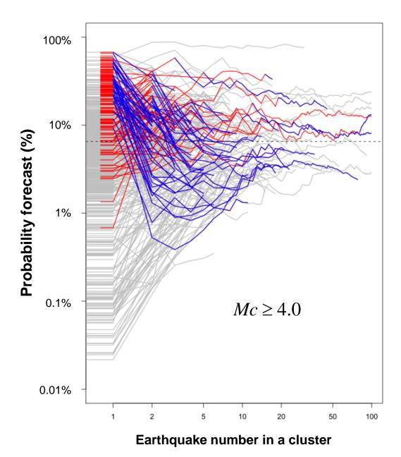
第4図.地震群に新らしい地震が加わった時,その順番(横軸)とその前震確率(縦軸). 前震(単発を含む)が赤線で,本震以後の予測確率が青線.その他の群れ(本震余震型または 群発地震型)が灰色線.横の点線は複数の場合の前震の全国平均(7.2%).
