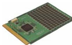
図 2 FDK の乱数発生装置のサブボード
