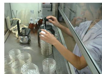
図4: バクテリアを用いた変化体の変異原性試験(提供 鹿児島大学工学部高梨研究室)
