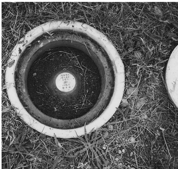
写真 3. 水準拠標(地面に埋められているのを真上より撮す).
