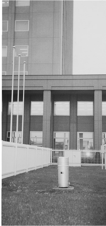
写真 1. 露場の雨量計(そばの建物が高すぎる).
